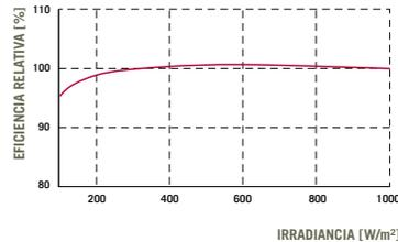
Típica potencia del módulo en condiciones de irradiación bajas en comparación con las condiciones STC (25 °C, 1000 W/m<sup>2</sup>).
