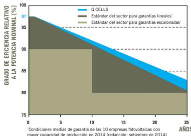
Un mínimo del 97% de la potencia nominal en el primer año. Después, un máximo del 0.6% de degradación anual. Un mínimo del 91.6% de la potencia nominal tras 10 años. Un mínimo del 83% de la potencia nominal tras 25 años.
